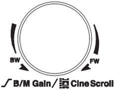
Questo comando ha una duplice funzione: in B-Mode dal vivo, gestisce il guadagno degli echi visualizzati; in B/M e M-Mode gestisce, invece, il guadagno degli echi timeline visualizzati. Nel B/M-Mode, il guadagno B-Mode può essere controllato dal comando Doppler/CFM Angle.
